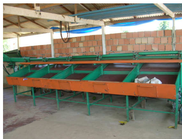
Fig. 09 Polidora de laranja – Parte frontal. Abreu, 2009.
